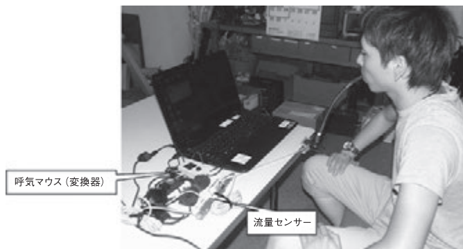
吸気マスクで画面上のカーソルを動かしている様子。上下左右の移動は息の強弱と吸う、吹く、の組み合わせで、右クリック・左クリックは短く強く吸う、吹く、で操作できる。
